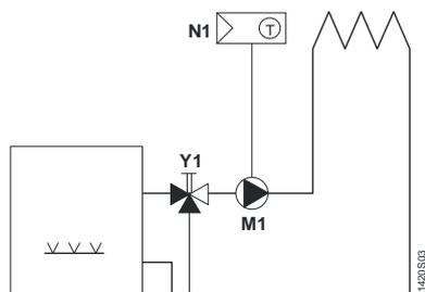
Прямое управление насосом контура отопления (предконтроль смесительным клапаном вручную)
